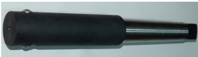
Фиг. 2. Устройство за диамантно заглаждане с двустранно действие
