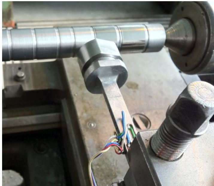
Фиг. 1. Експериментална установка за определяне на коефициента на триене при плъзгане
