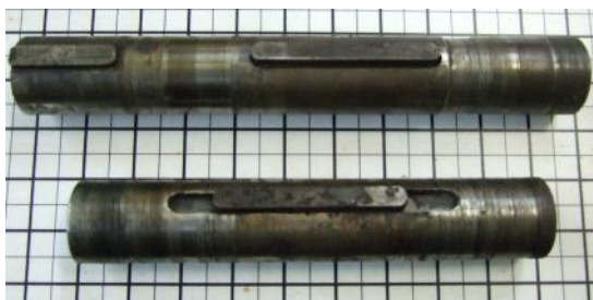
Фиг. 4. Задвижващ и задвижван вал в стружкочупещ дробилка
