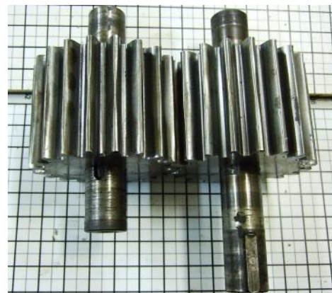
Фиг. 2. Технологична зъбна предавка от стружкочупец механизъм
