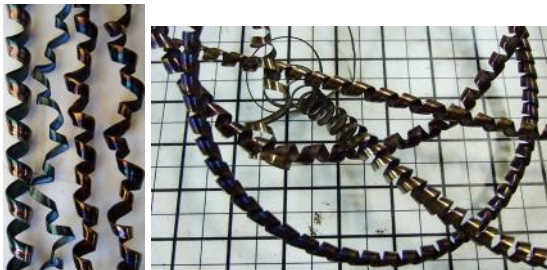
Фиг. 1. Стружки от обработката на лагерните гривни
