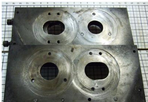
Фиг. 3. Износени повърхнини от вътрешната част на стените на корпуса на механизма
