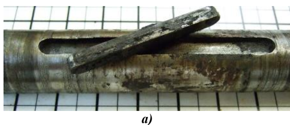
Фиг. 5 Разглобено шпонково съединение вал-верижно колело: а) входящ край на задвижващия вал; б) верижно колело, задвижващо вала на механизма.
