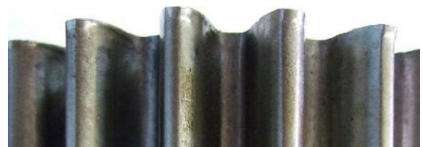
Фиг. 6. Пластично деформиране на зъбите в процеса на експлоатация на зъбната предавка
