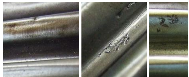
Фиг. 5. Задиране по зъбните повърхнини
