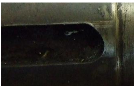
Фиг. 14. Разбит шпонков канал във вала под главината на колелото
