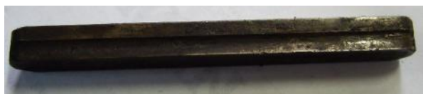
Фиг. 13. Шпонка под зъбното колело със смачкани странични повърхнини
