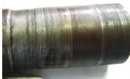
Фиг. 17. Задрала лагерна шийка на вала
