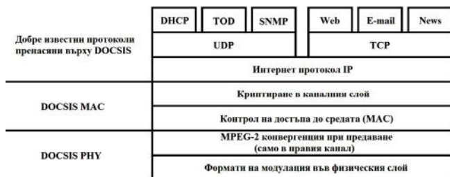
Фиг. 2. Протоколен стек на DOCSIS кабелен модем
