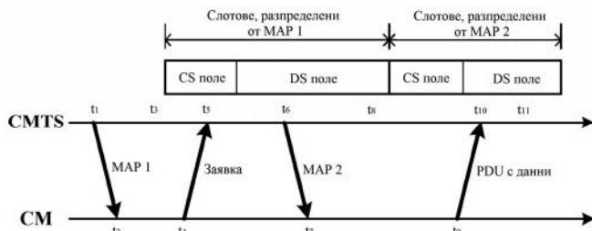
Фиг. 3. Работен поток по DOCSIS-протокол
