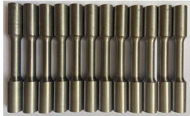
Fig. 2. AISI 4140 tensile test specimens
