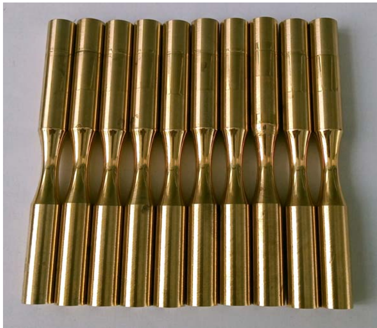
Фиг. 5. Образци обработени посредством ДЗ с шест прехода и еднопосочна работна схема
