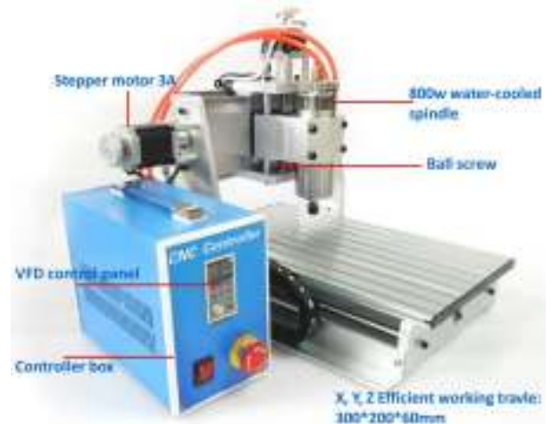
Fig. 4. Table milling machine «CNC 3020 mini» (Ukraine)
