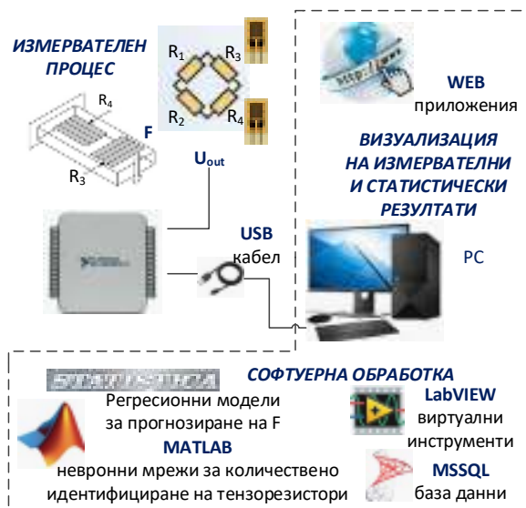
Фиг. 1. Архитектура на система за анализ на сили върху метали посредством тензорезисторни преобразуватели
