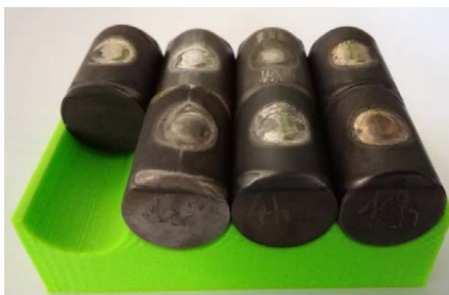
Фиг. 3. Цилиндрични пробни тела за експериментално изследване на остатъчни напрежения посредством X-Ray Diffraction метод
