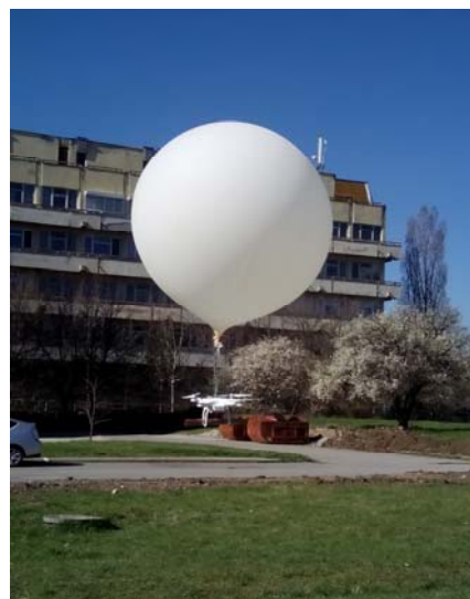
Фиг. 2. Фотография на системата балон-мултиротор в режим на издигане. Балонът е тип Totex Corp., Япон, запълнен с Хелий. Квадрокоптерът е тип Phantom 2
