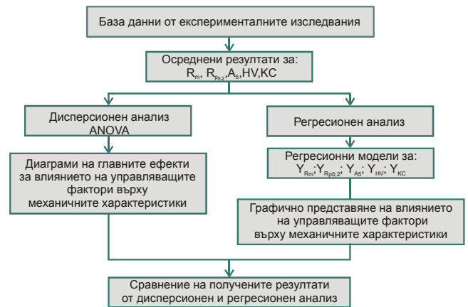
Фиг. 6 Блок-схема за моделиране на механичните характеристики
