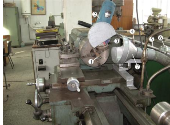
Фиг. 1. Приспособление за еластично абразивно отрязване: 1 – обработвана заготовка; 2 – ъглошлифовъчна машина; 3 – отрезен диск; 4 – ос за лагеруване; 5 – рамо; 6 – противожегест; 7 – аспирационна уредба
