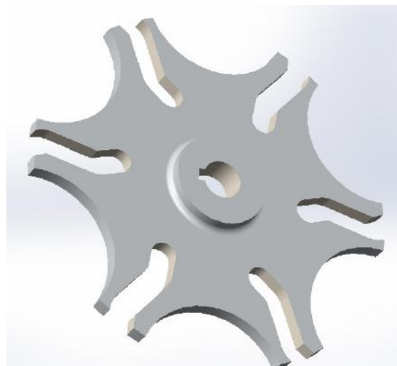
Фиг. 11 МК с S-образни канали с оптимални геометрични параметри
